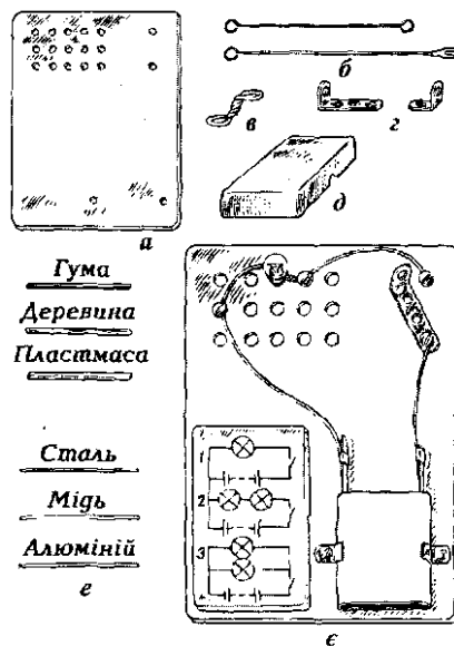
Рис. 137. Монтаж електричного кола
