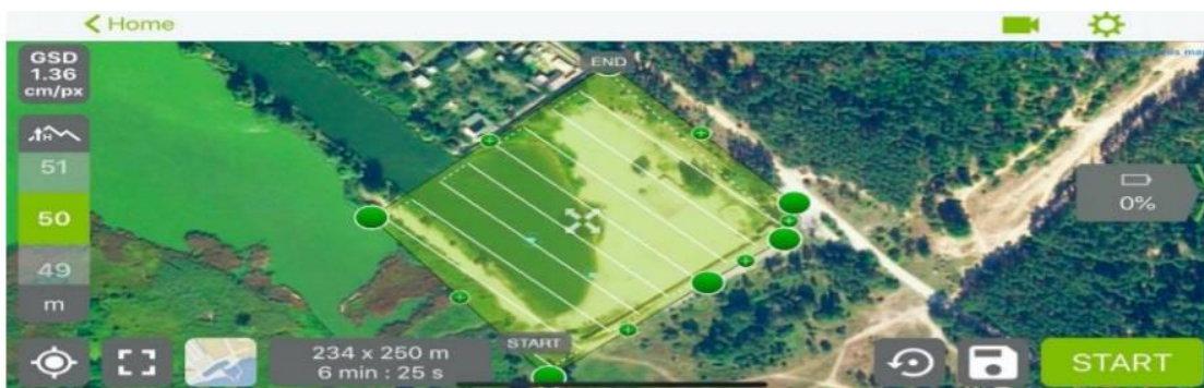
Рис. 4. Вікно планування аерофотозйомки в Pix4DCapture
